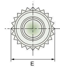
Einpressgewindebolzen aus nicht rostendem Stahl (AISI 300er Serie), geeignet für die Verarbeitung in Blechen mit Härten bis HRB 70.
